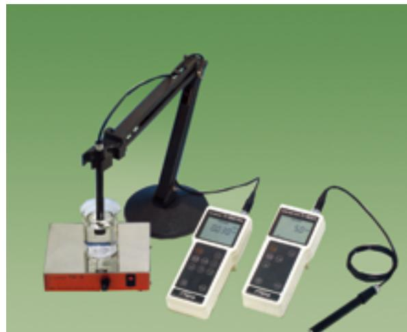
適用於工業廢水，下水道、河川、海水、養殖業等之氨離子測定。
